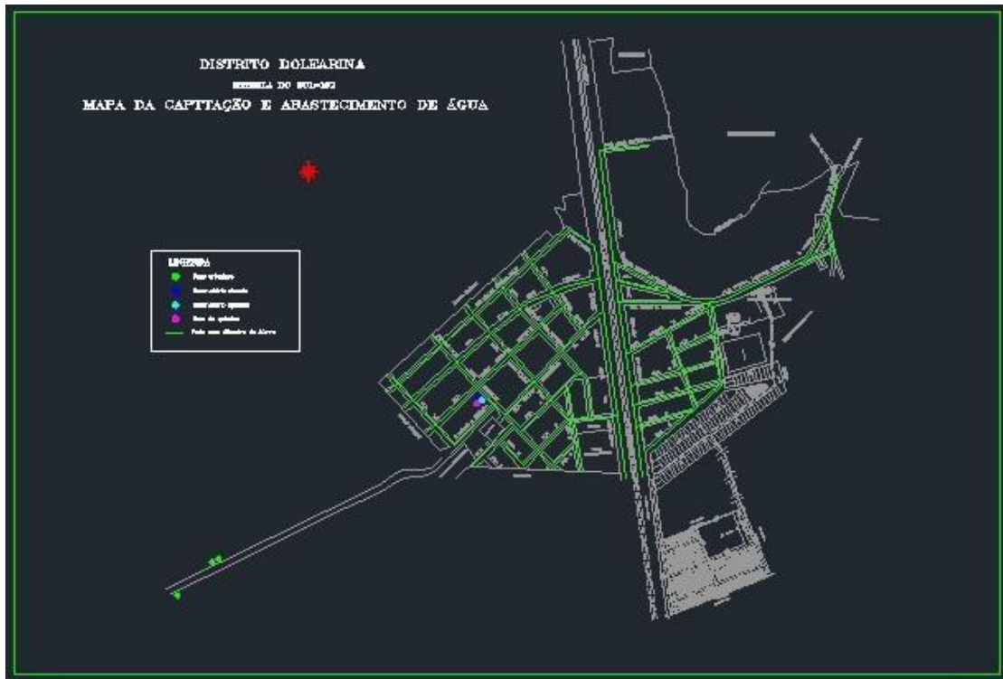
Figura 38: Sistema de distribuição de água
