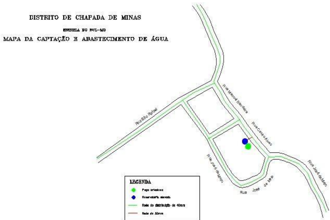
Figura 47: Sistema de distribuição de água
