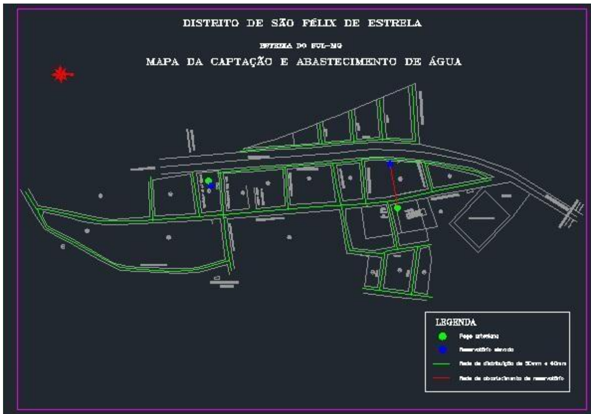
Figura 43: Sistema de distribuição de água
