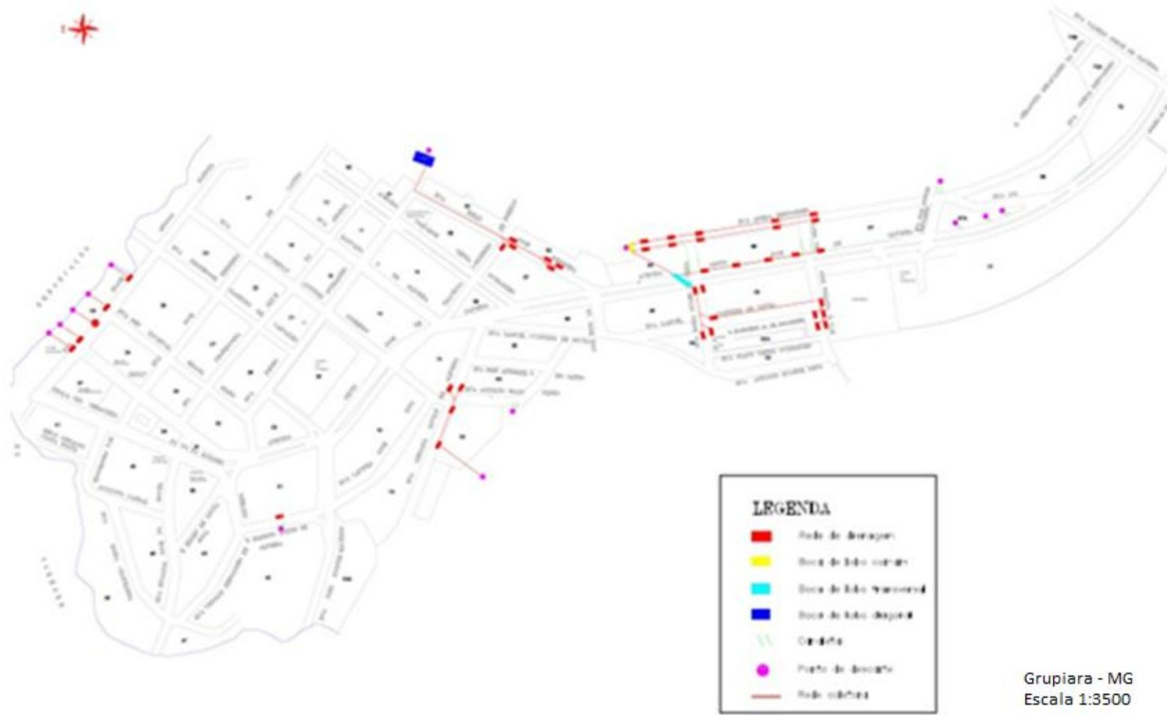
Figura 39: Sentido do escoamento da água pluvial
